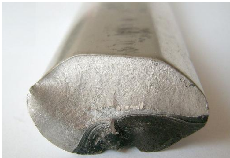
Рис. 9.1 – Разрушение шатуна: темная зона – усталостное разрушение, светлая – хрупкий излом
